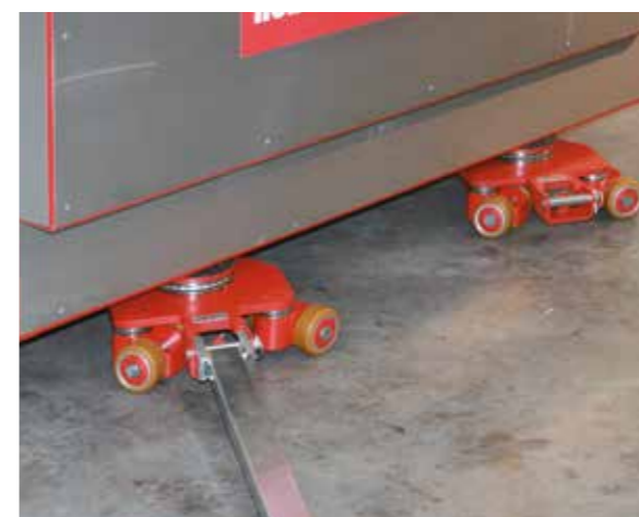
Toepassingsvoorbeeld als tandemstuursysteem
