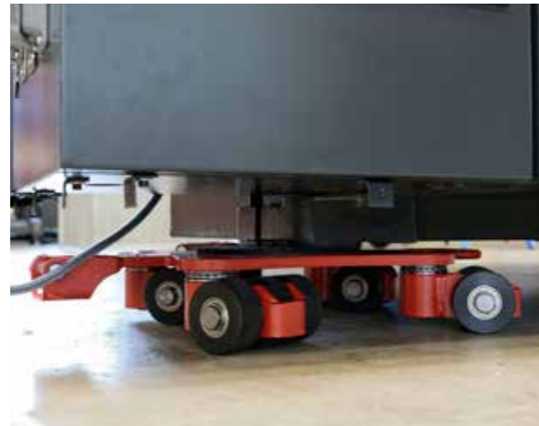
Draaibare transport cassette JKB in actie.
