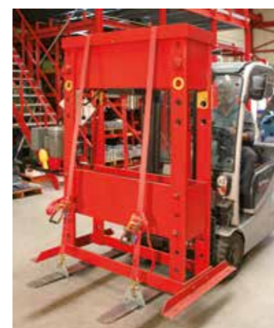
Ladingbeveiliging met heftruckklemmen en trekbanden
