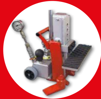
Hefinrichting met speciale houder / speciale band
