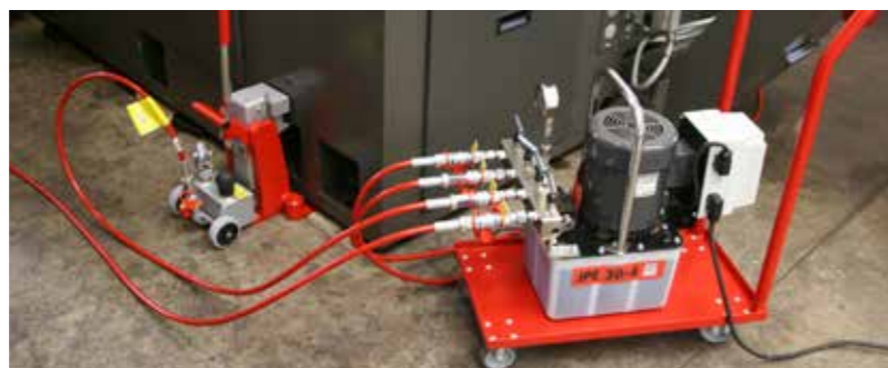
Elektrische pomp JPE 30-NVR met twee machineheffers in actie.
