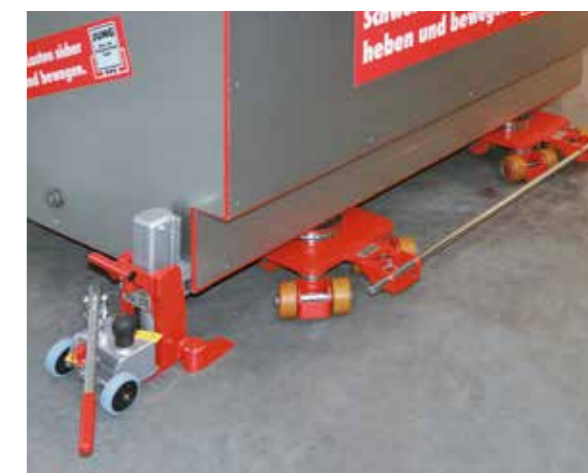
Toepassingsvoorbeeld als star chassis
