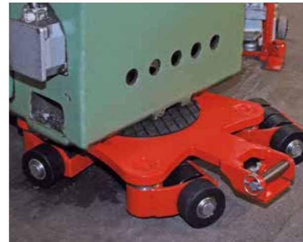
Draaibare transport cassette JKB in actie.
